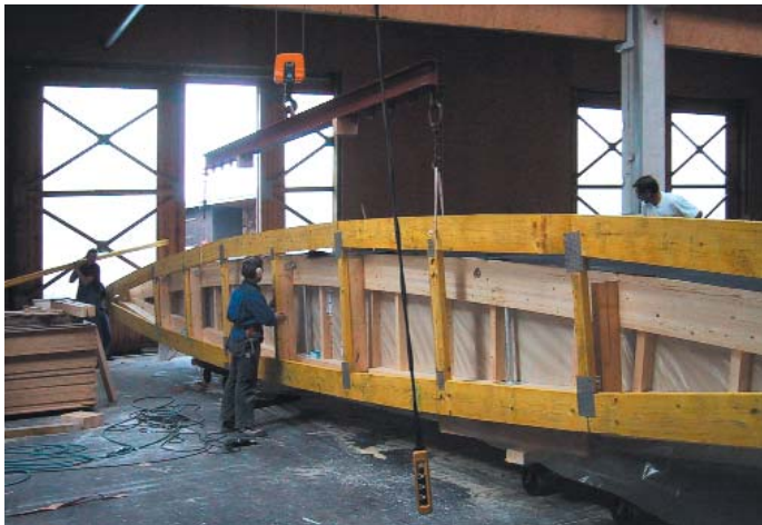
Runde Formen für den schnellen Hunger: Element für ein Burger-King-Restaurant in neuer, runder Bauweise kurz vor der Fertigstellung im Werk in Waffensen
